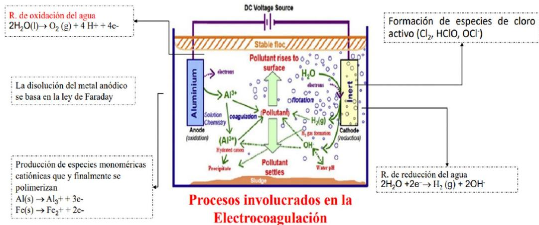
Figura 7. Reacciones involucradas en la electrocoagulación.
