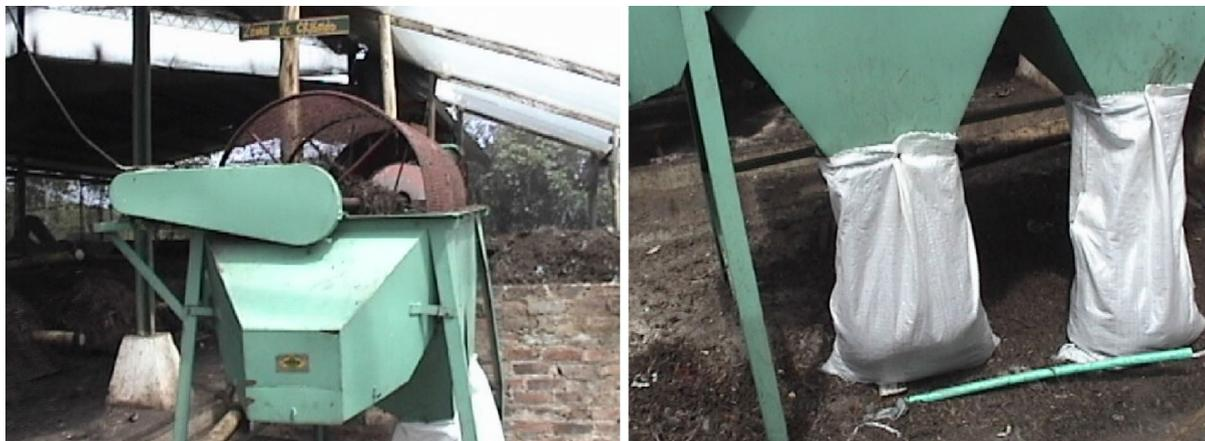
Fotos de área de secado y cribadora con empacadora del producto final.
