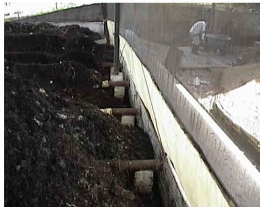
Fotos aireación forzada en conformación de pilas compostadas con aire caliente.
